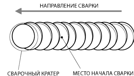
Рис. 9.4. Начало сварки при смене электрода.
